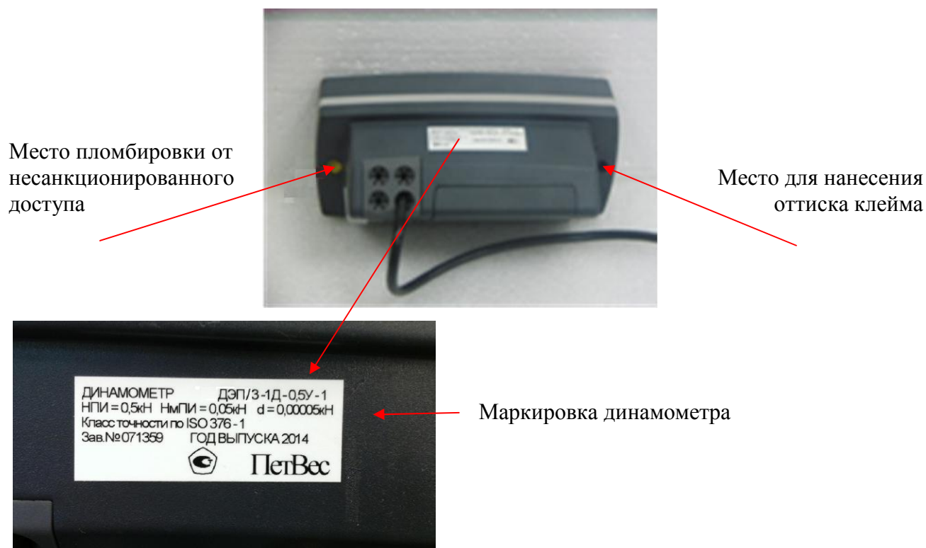
Рисунок 9. Схема пломбировки от несанкционированного доступа и обозначение места для нанесения оттиска клейма
